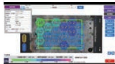
締固め施工情報の統一管理(管理PCの画面)
