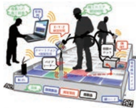
コンクリート締固めAR管理システム概念図
