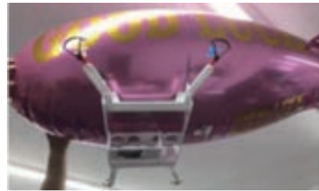
図-2 函内監視用気球型ドローン試作機
