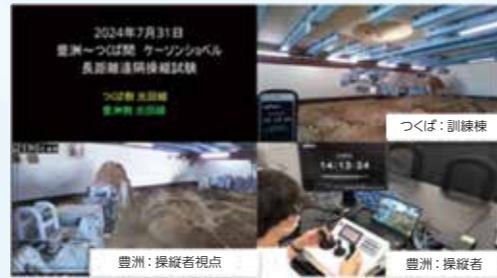
図-2 豊洲オフィスとつくば研修施設間の遠隔操縦試験
