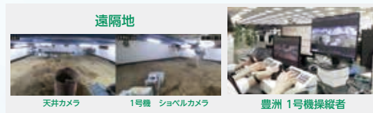
図-2 豊洲オフィスとつくば研修施設間の遠隔操縦
