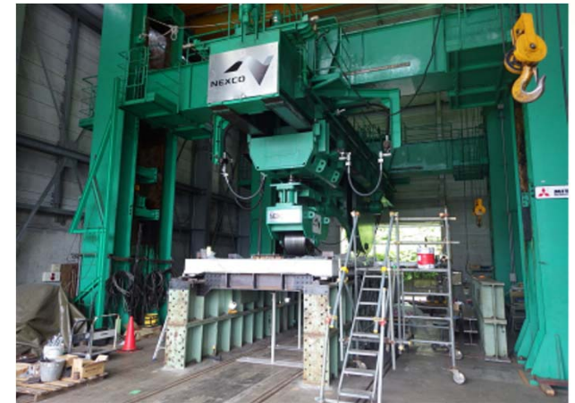
PC床版に適用するための輪荷重疲労載荷試験
