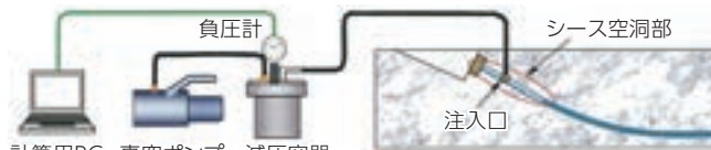
理想気体の状態方程式によりシース内の空洞量を推定
